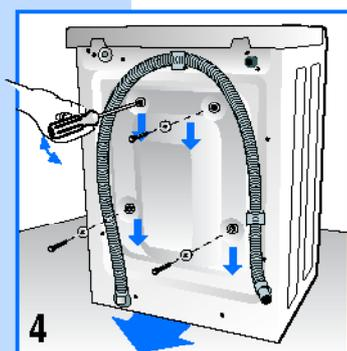
Для транспортировки прибора его качающийся узел блокирован 4 распорками с болтами. Прежде чем подключить машину, при помощи гаечного ключа следует вынуть транспортировочные болты.
