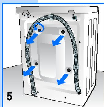
Вставьте в отверстия отвертку и выньте 4 пластмассовые распорки, как показано на рисунке.
