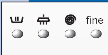
На рисунке приведены 4 основных фаз цикла стирки: **ПРЕДВАРИТЕЛЬНАЯ СТИРКА- ОСНОВНАЯ СТИРКА, ПОЛОСКАНИЕ, ОТЖИМ, ОКОНЧАНИЕ.** Во время выполнения цикла каждая из этих функций будет обозначаться включением соответствующей контрольной лампочки. Таким образом, можно узнать какая фаза цикла выполняется в данный момент.
