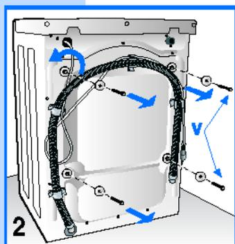
Для транспортировки прибора его качающийся узел блокирован 4 пластмассовыми распорками с болтами. Прежде чем подключить машину, следует вынуть распорки и транспортировочные болты и сохранить их на случай переезда.
